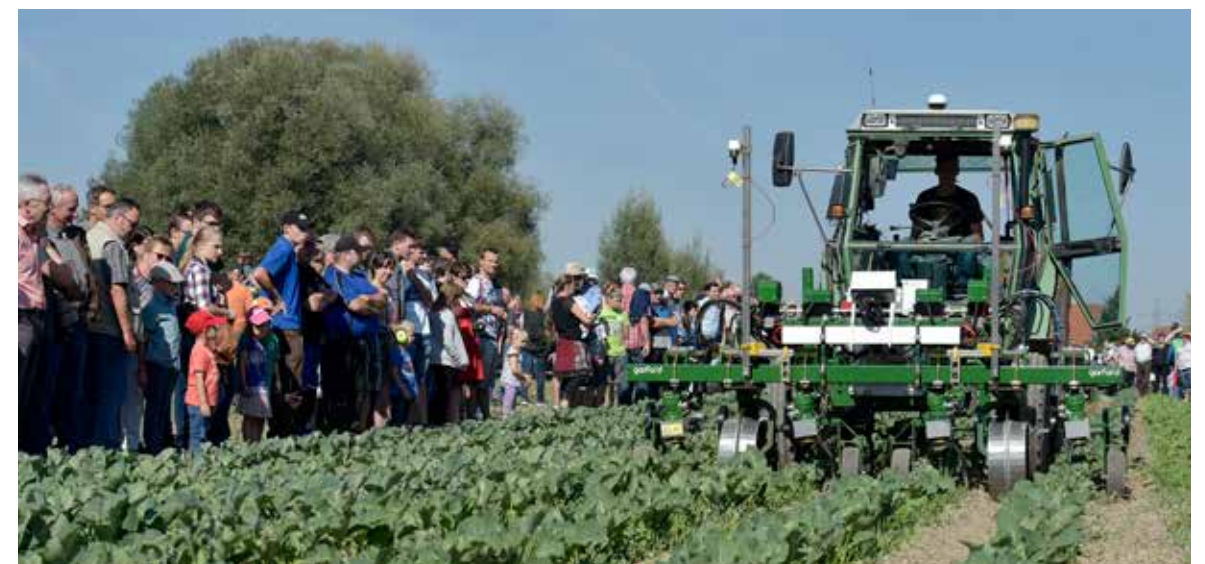
Unkrauthacken im Jahr 2018: Der Traktor hat die Reihen der Krautköpfe beim Setzen der Pflanzen exakt abgespeichert. Das Hackgerät arbeitet mit Kameras, die jede Pflanze einzeln lokalisieren.
